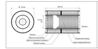
Пламегаситель универсальный 95/290-54 с перфорированным диффузором (нержавеющая сталь)
