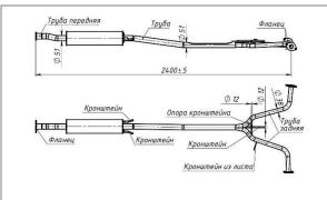
Глушитель для автомобилей Nissan Teana (08-) 2.5 дополнительный (резонатор) алюминизированная сталь
