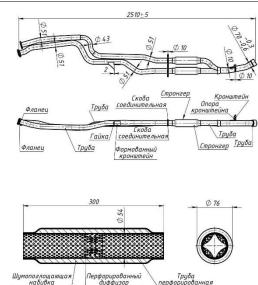
Глушитель для a/м BMW 5 E60 (03) 2.5i дополнительный (резонатор) алюминизированная сталь
