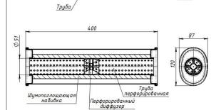
Глушитель для автомобилей Nissan X-Trail T31 (07-) 2.5i дополнительный (резонатор) алюминизированная сталь
