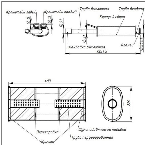
**Глушитель для автомобилей SAAB 9000 (85-) 2.0i/2.3i основной (алюминизированная сталь)**
