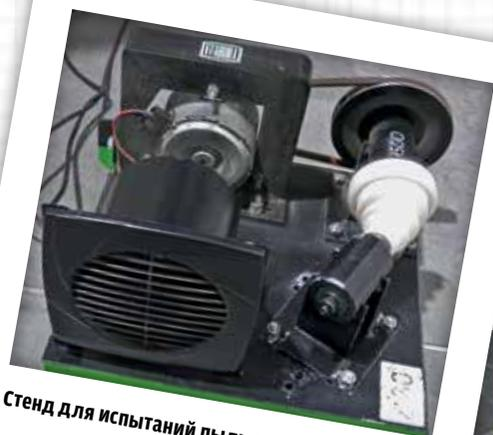
Стенд для испытаний пыльников ШРУСов.
