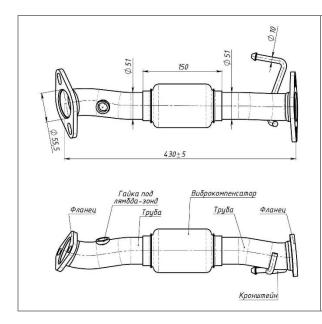
Труба приёмная для автомобилей Hyundai ix35 (10-)/Кіа Sportage III (10-) 2.0і алюминизированная сталь
